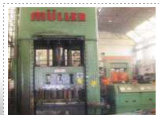
Hydraulic press Muller ZES 250/320.1.2. 315 tons
